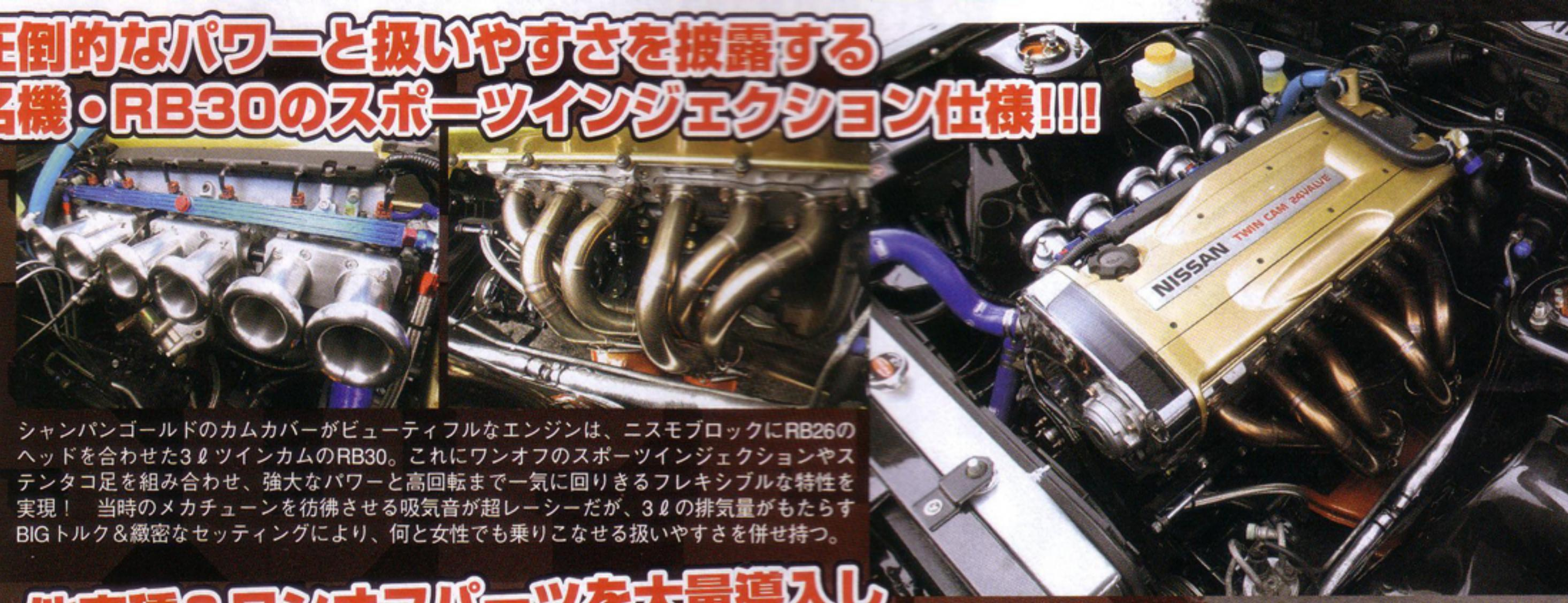
シャンパンゴールドのカムカバーがピューティフルなエンジンは、ニスモブロックにRB26のヘッドを合わせた3lツインカムのRB30。これにワンオフのスポーツインジェクションやステンレス足を組み合わせ、強大なパワーと高回転まで一気に回りきるフレキシブルな特性を実現! 当時のメカチューンを彷彿させる吸気音が超レーシーだが、3lの排気量がもたらすBIGトルク&緻密なセッティングにより、何と女性でも乗りこなせる扱いやすさを併せ持つ。
